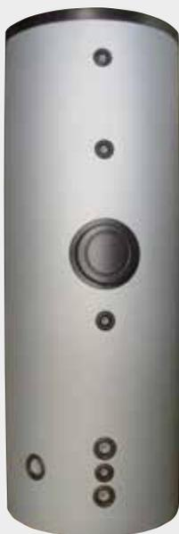
Bollitore superiore a 2 serpentini in acciaio al carbonio, completo di protezione anodica, trattamento interno di vetrificazione secondo normative DIN 4753-3 e UNI 10025. Accumulo inferiore per acqua di riscaldamento o refrigerata, interno non trattato.
