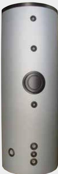
Bollitore superiore a 1 serpentino in acciaio al carbonio, completo di protezione anodica, trattamento interno di vetrificazione secondo normative DIN 4753-3 e UNI 10025. Accumulo inferiore per acqua di riscaldamento o refrigerata, interno non trattato.
