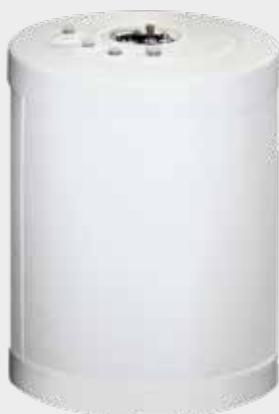
Bollitore a 1 serpentino in acciaio al carbonio, completo di protezione anodica, trattamento interno di vetrificazione secondo normative DIN 4753-3 e UNI 10025.
