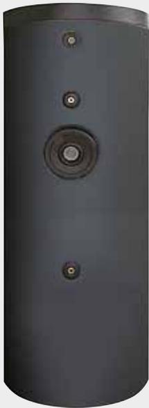
Bollitore a 2 serpentini in acciaio al carbonio, completo di protezione anodica, trattamento interno di vetrificazione secondo normative DIN 4753-3 e UNI 10025.
