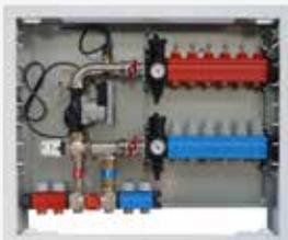
Gruppo di miscelazione e distribuzione per regolazione climatica in polimero da 1", con derivazioni 3/4"x18 Ek dotato di flussimetri per il bilanciamento della portata in mandata e di predisposizione per attuatori elettrotermici in ritorno, by-pass differenziale, attatore 0-10 Vac, valvole a sfera con termometro, pompa di circolazione e rubinetti di carico/scarico. Comprensivo di cassetta.
